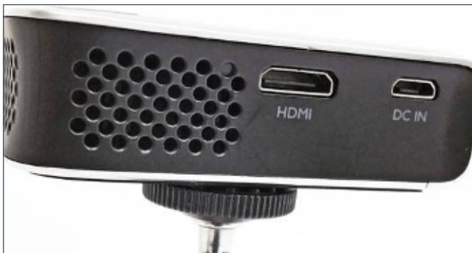
Einmal HDMI und Micro-USB-Strom – mehr Anschlüsse braucht der Picopix-Beamer nicht.
