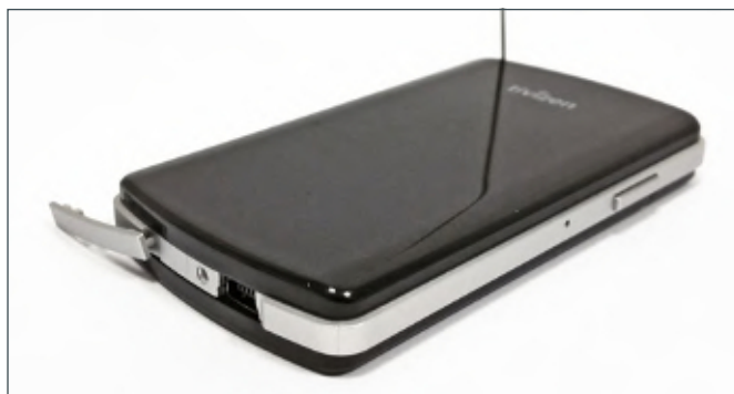
DVB-T-Empfänger, Wifi-Hotspot, dicker Akku, Antenne – der Tivizen ist ein echtes Technik-Paket!
