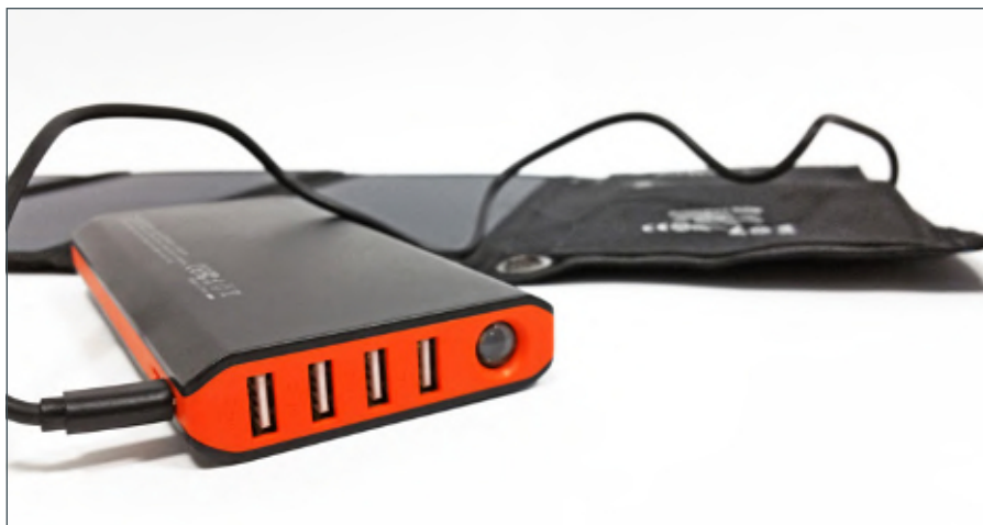
Eine Powerbank glättet den Strom einer Solaranlage und schont so die Endverbraucher. Schließt möglichst immer eine Powerbank an.
